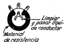
FIG. 56. — Rejuvenecimiento de un potenciómetro de carbón.
