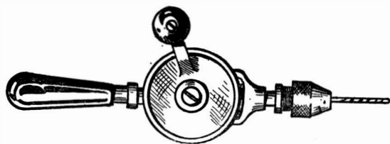
FIG. 12. — Modelo práctico de taladro de mano para uso en radio.
