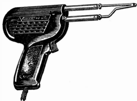
FIG. 4. — Soldador instantáneo de uso corriente en radio.
