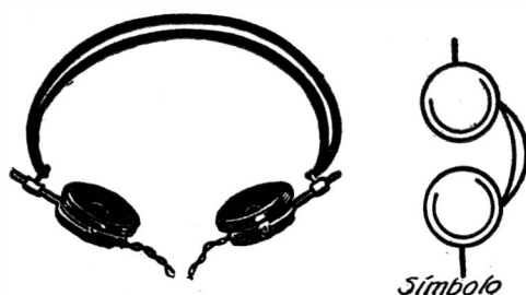
FIG. 50. — Aspecto y símbolo de los auriculares telefónicos.
