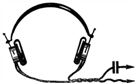
FIG. 16. — Un auricular telefónico para revisar circuitos de audio.
